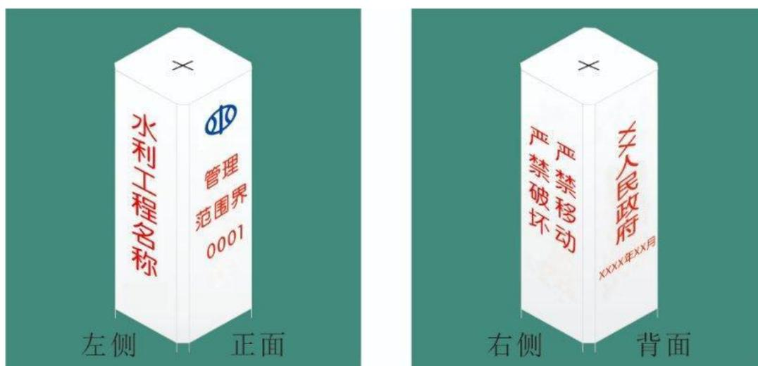
图 4-12界桩标注样式示意图
